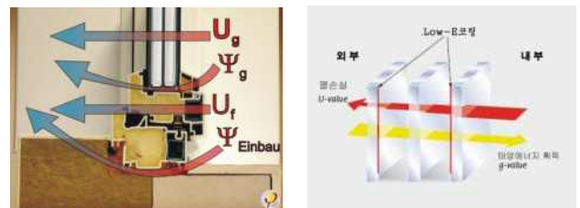
그림 5. 삼중 창호의 구조 및 일사투과
