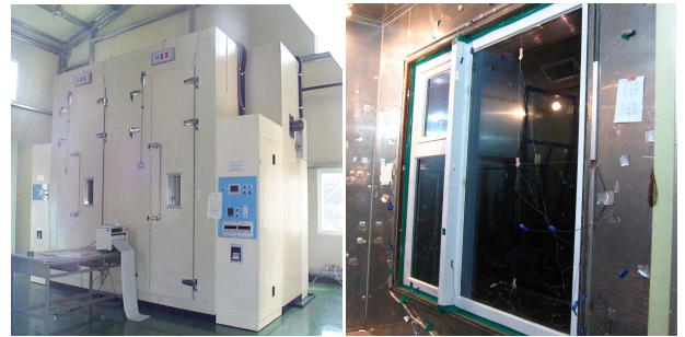
(a) 창호 단열성 실험 챔버 (b) 테스트제품 설치모습(Type1)
