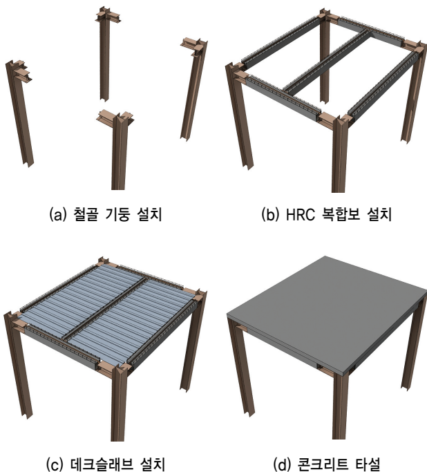
[그림 3] 겔버 접합형 HRC 복합보 시공순서
