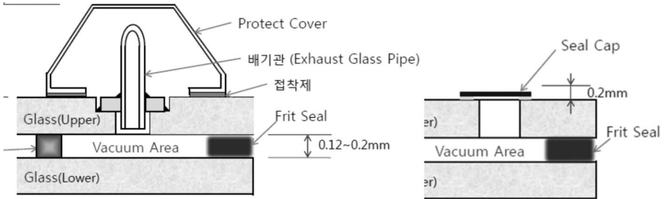
[그림 7] 1세대 및 2세대 진공유리의 Cap 공정의 차이 [출처: GT&E]
